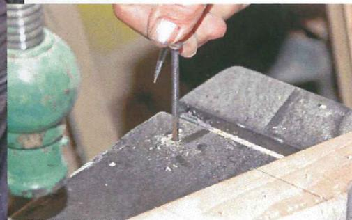
Pour définir l'angle en biais réalisé au moyen de la mortaiseuse, le gabarit est constitué de deux pointes qui viennent prendre place dans des logements sur la table de la mortaiseuse, réalisés par Aimé, encore une astuce
