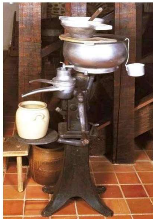
Ecrémeuse avec les accessoires à lait : à gauche, le pot à crème, à droite, le gobelet mesureur, en haut, l'écumoire à petit-lait
