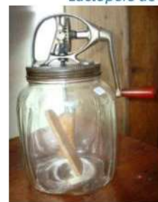
Petit ribot en verre perfectionné par sa manivelle entraînant un manche garni d'une pale en bois. Le temps du barattage en est raccourci.
