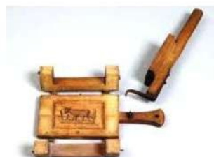
La tige reliée à l'étampe (décor) faisait office de piston pour vider le beurre une fois durci.
