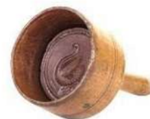
La tige reliée à l'étampe (décor) faisait office de piston pour vider le beurre une fois durci.
