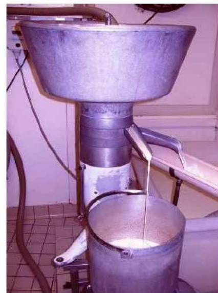
Écresseuse en marche : la crème plus légère sort par le tuyau de gauche situé plus haut que l'autre de droite d'où sort le lait écrémé.
