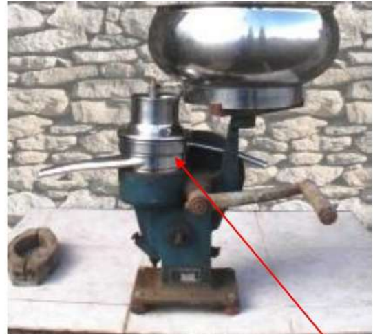
Dans le tambour, il y a une succession de disques séparés les uns des autres par de petits intervalles où se répand le lait et communiquant avec l'axe central par de petites fenêtres. Quand le lait divisé en couches très minces est soumis à la force centrifuge, la crème plus légère se rassemble au centre et ressort par le tube correspondant.
